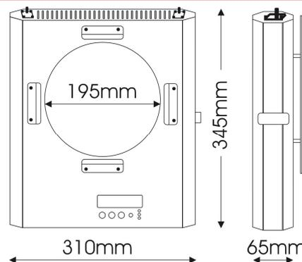
Colour scroller a controllo DMX512 e RDM, dal posizionamento colore estremamente accurato e funzionamento particolarmente silenzioso.
