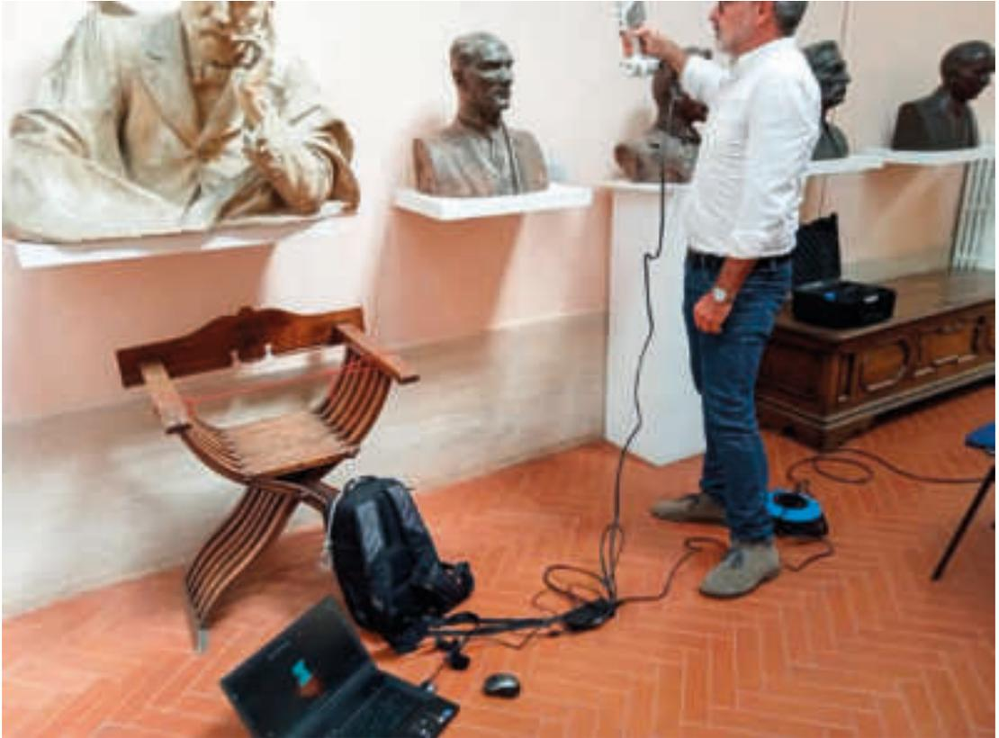
**Fig. 3** Museo Canonica, Roma. Fase di acquisizione dei dati relativi al busto di Mustafa Kemal Atatürk tramite scanner Handheld (foto di F. Colonnese).
